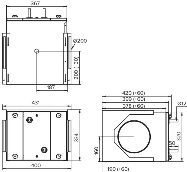
**Uppvärmningskapacitet (0.6...1.5 kW)**Etylenglykol 25%, flöde 0,1 dm<sup>3</sup>/s
