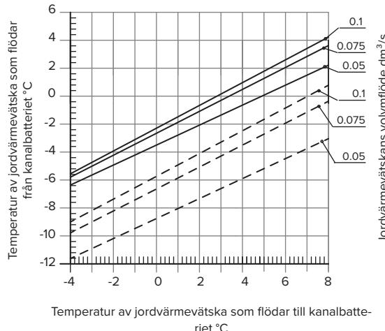
**Nedkyllningskapacitet**Etylenglykol 25%, flöde 0,1 dm<sup>3</sup>/s
