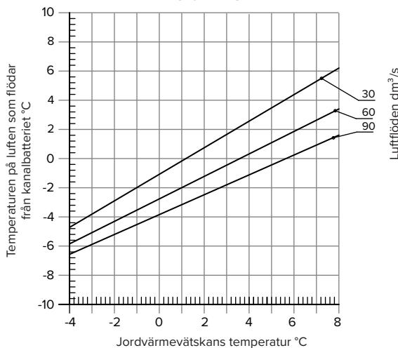
**Jordvärmevätskans nedkyllning**etylenglykol 25 %, luftflöde 90 dm<sup>3</sup>/s
