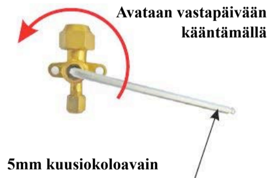
6. Avaa huoltoventtiilit kokonaan auki 5mm kuusiokoloavaimella vastapäivään kääntämällä.
