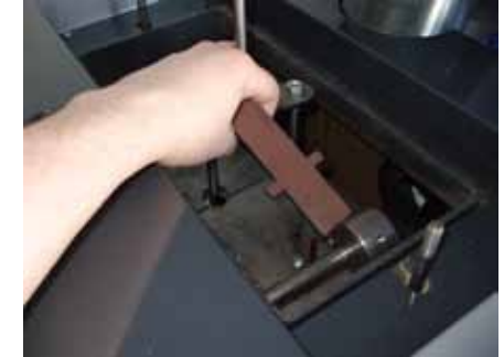
3. Nosta keinuvipu pois paikoiltaan.
