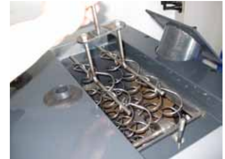
6. Nosta pidin ja spiraalit pois konvektiosta.
