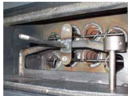
8. Asenna kaikki spiraalit ja nostotanko paikoilleen kuvan osoittamalla tavalla.
