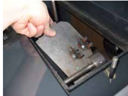
5. Nosta myös toinen konvektiokanavan kansi pois.
