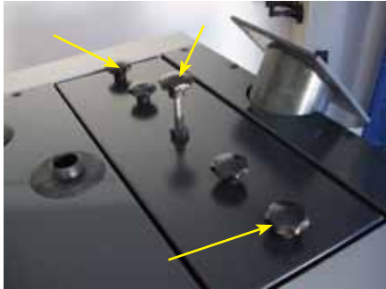
1. Avaa ulommaiset ja keskimmäinen tähtinuppi ja nosta puhdistusluukku pois.
