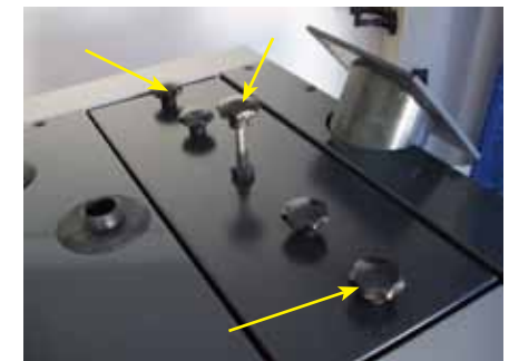
10. Asenna puhdistusluukku paikoilleen ja kiinnitä tähtinupit.
