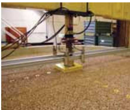
BRE:n kantavuuskokeet vahvistavat, että TriAx-geoverkot jakavat kuormat laajemmalle.
