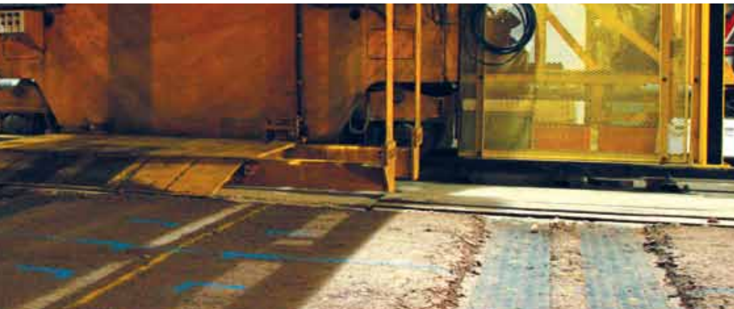
TRL:n liikennöintikokeet osoittivat TriAx'in toimivan paremmin kuin Tensarin kaksiaksiaaliset geoverkot.
