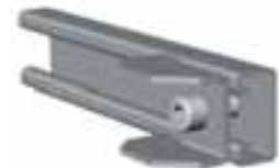
C 60-XA Ylimääräinen ankkurikisko, joka voidaan asentaa CDC 60 -kaapin peitelevyn alle. Käytetään kaapin vaihdossa, kun kaapelia on jatkettava ja jatkoskohta ankkuroitava.
