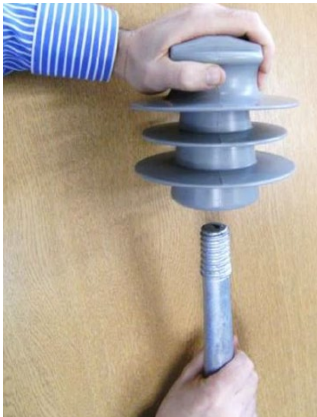
Kuva 2 Varmista ettei eristin kiristy väärille kierteille
