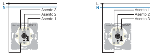
Kuva 1: 3-askelkytkin nolla-asennolla [Tyyppi 3861] / 3-askelkytkin ilman nolla-asentoa [Tyyppi 386101]
