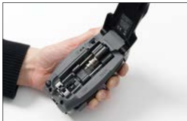
4. Paina painiketta niin, että kelkka liikkuu alas ja pitää liittimen oikeassa asennossa.
