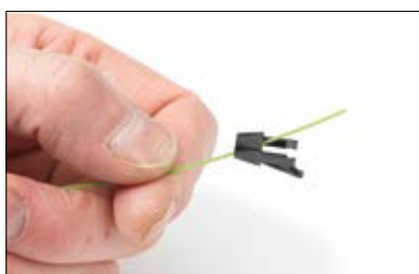
10. LC-kuituliitintä kytkettäessä liitinpidike tulee sijoittaa paikoilleen ennen kytkemistä.
