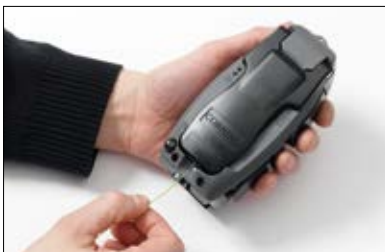
22. Työnnä katkaistu ja valmisteltu kuitu työkaluun kiinnitettyyn kuituliittimeen.
