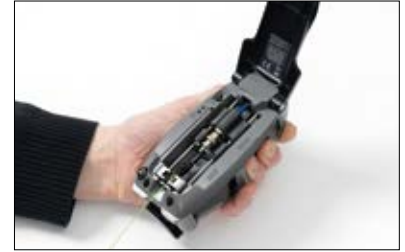
27. Siirrä kelkka ulos ja vapauta kuituliitin painamalla oikealla ylhäällä olevaa painiketta.
