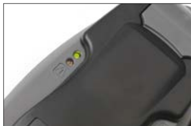
8. Sulje ja lukitse työkalun kansi, tarkista että vihreä lamppu palaa. Jos lamppu ei pala, avaa kansi ja sijoita kuituliitin oikein.
