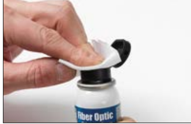
14. Laita yksi painallus puhdistusnestettä nukkaamattomaan liinaan.
