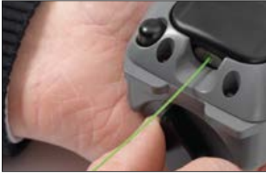
25. Poista kuidun vetorasitus kääntämällä kahvaa 180 astetta.
