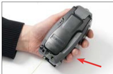
23. Kun kuitu on työnnetty kokonaan kuituliittimeen, se lukitaan painamalla työkalun alinta painiketta.
