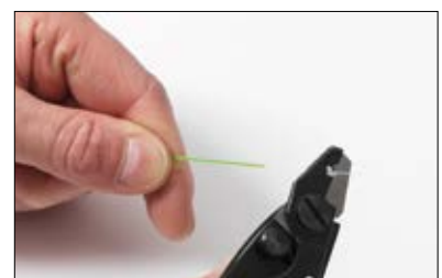
12. Kuori ja poista kaikki peite kuidusta käyttäen kuorintapihtien sisäosaa. Vedä vielä kerran pihdeillä sen varmistamiseksi, että kuitu on täysin puhdas.
