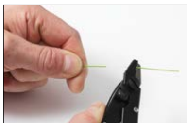
11. Kuori ulkoeristettä vähintään 40 mm. Käytä kuorintapihtien ulko-osaa.
