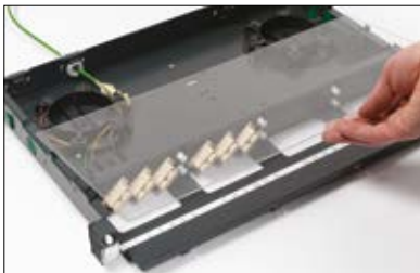
4. Kytke kuituliittimet adaptereihin. Varmista, ettei kuitukaapelia taivuteta missään vaiheessa liikaa. Asenna suojakansi paneelin päälle.
