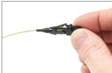
29. Kiinnitä liittinpidike ja taivutussuoja.
