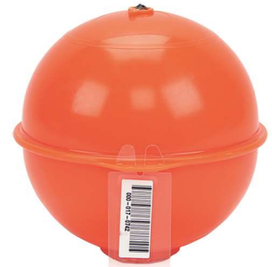
3M™ EMS Palloantenni Nestepinta asettuu aina oikeaan asentoon, asennettavissa 1.0 - 1.5 m syvyyteen hakulaitteesta mitattuna.
