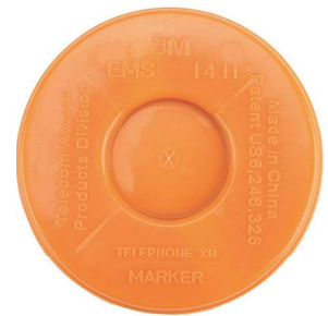
3M™ EMS Kiekkoantenni Enintään 1.2 m syvyyteen hakulaitteesta mitattuna, ei sovellu haudattavaksi suoraan maahan.
