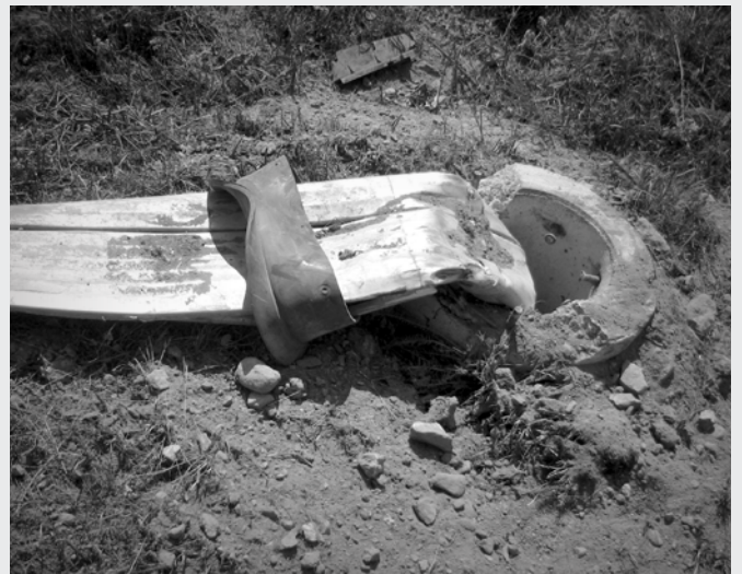
Törmätty KAPU-HE -pylväs Vt 7 Suomessa
