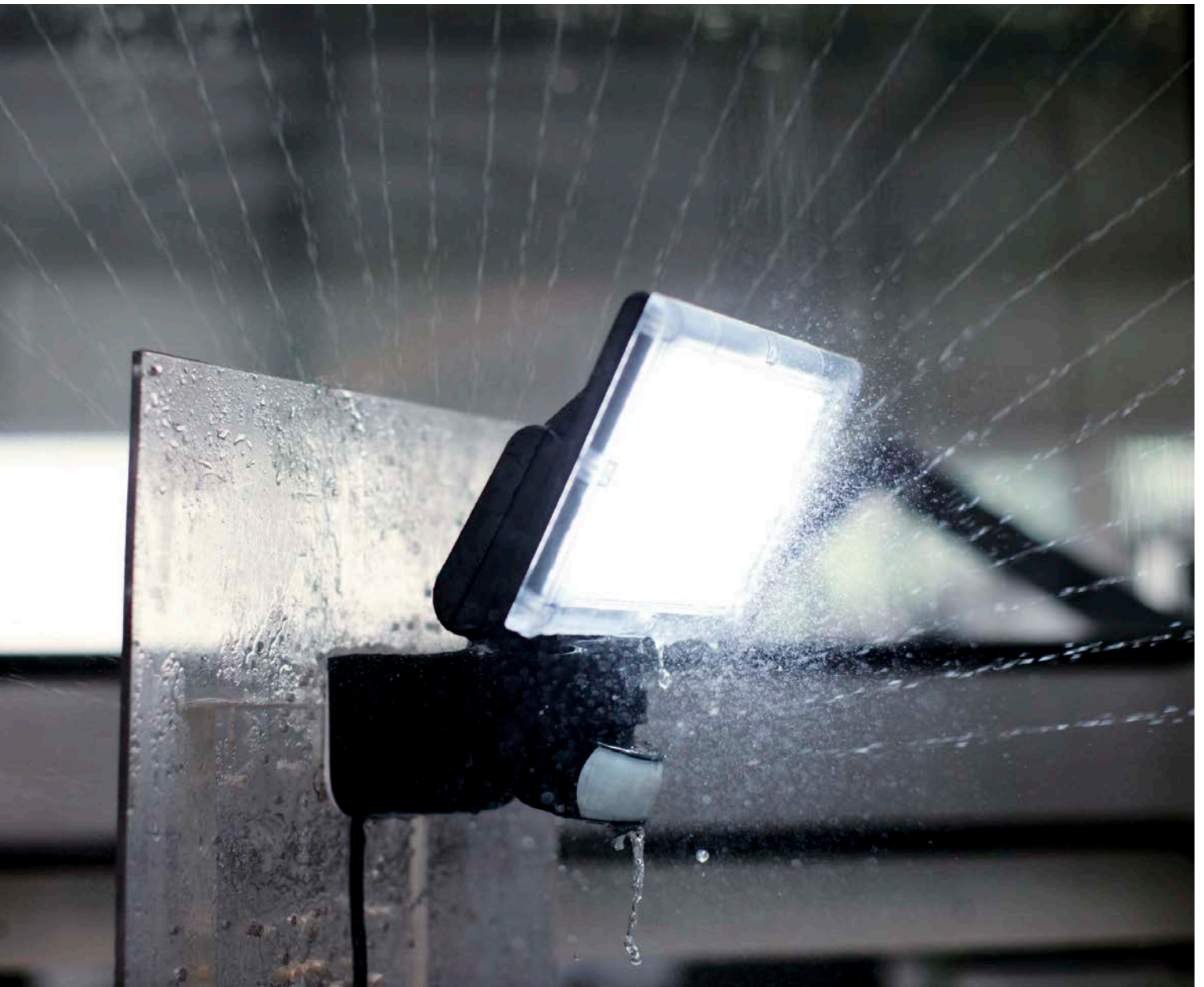
XLED home 1 kovassa koetuksessa: Roiskevesitestimme takaa säänkestävyyden ja kotelointiluokan IP44.
