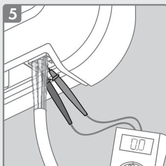
**GEFAHR:** Erst **nach** Schritt 5 ist der Wechselrichter spannungsfrei!
