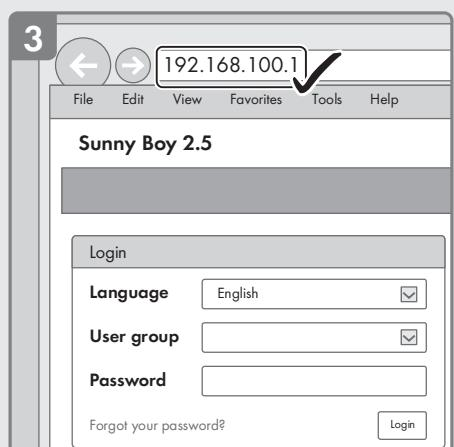
**K** Wechselrichter über Ethernet konfigurieren | Configuring the inverter via Ethernet | Διαμόρφωση μετατροπέα μέσω Ethernet | Configuración del inversor mediante ethernet | Configuration de l'onduleur via Ethernet | Configurazione dell'inverter mediante Ethernet | Konfigurace střídačů prostřednictvím Ethernetu | Omvormers via ethernet configureren | Konfiguracja falownika poprzez Ethernet | Configurar inversores via Ethernet | Konfigurering af omformeren via ethernet
