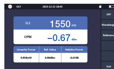
7. Medidor de Pérdida Óptica / Optical Loss Test
