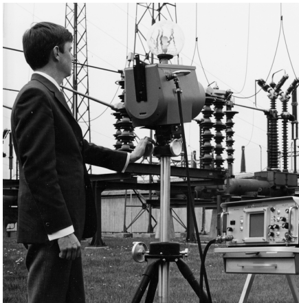
1969: Thermovision, malli 661. Kamera painoi noin 25 kg, oskilloskooppi 20 kg ja jalusta 15 kg. Käyttäjä tarvitsi myös 220 V:n vaihtovirtageneraattorin ja 10 litran säiliön nestemäistä tyypeä. Oskilloskoopin vasemmalla puolella näkyy Polaroid-lisäosa (6 kg).
