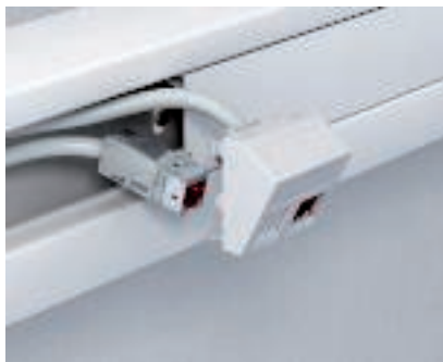
Liittimen kiinnitys kanavadatastasiaan Valmiiksi asennettu liitin sijoitetaan takapuolelta kanavadatastasiaan tyyppi C ja painolukitaan.
