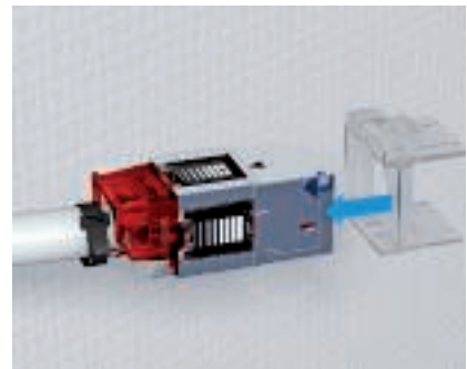
Liittimen kytkentä - kiinnityskehys asennus Keystone-kiinnityskehys sijoitetaan edestä liittimeen ja painolukitaan.
