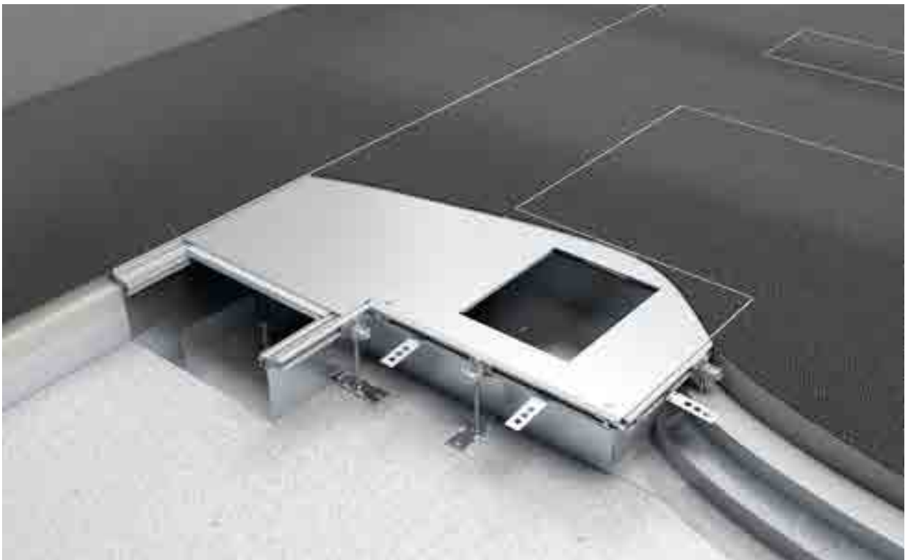
Lattiapinnoite asennetaan kansiin ja valuu. Lattiapinnoitteiden väliin asennetaan saumaprofiili joka estää lian pääsemisen väliin. Kannen alle voidaan asentaa tiiviste, jolloin kanava soveltuu myös märkäpuhdistettaviin lattioihin EN50085-2-2.
