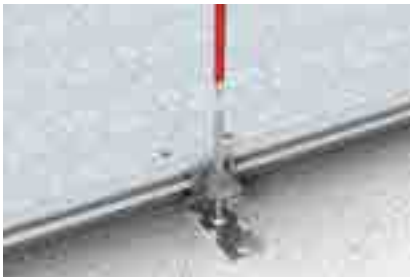
Lattiakanava säädetään pintavalun kanssa samalle korkeudelle säätöjalkojen avulla. Säätöjalka toimii samalla myös jatkokappaleena.
