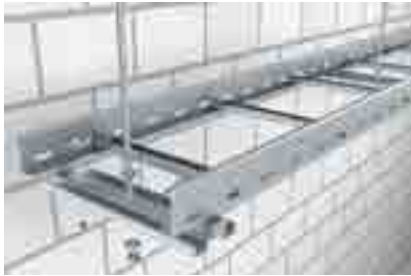
MAHL Matala keskikannake Ø13 reikä kierretangolle. Tikashylly kiinnitetään keskikannakkeeseen LKS 40 kiinnityskappaleella. Kaapelikuorma jaettava tasaisesti.
