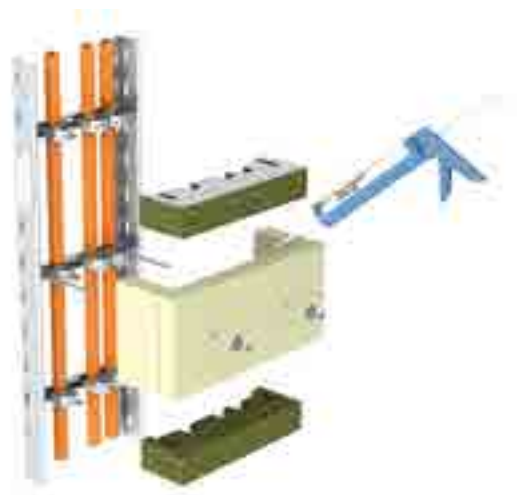
Kaapelit kiinnitetään pieniin kaarikiinnikkeillä. Sopivat kiinnikkeet löytyy kiinnike-osiosta.
