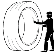
Älä pura päällysmuovia, vaan aloita kelan purkamisen sisältä käsin!
