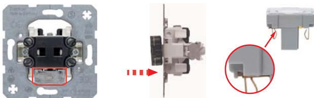
Kuva 1: Hohtolamppuyksikkö (ilman kytkimen irrotusta) voidaan lisätä tai vaihtaa etupuolelta. Sovelluksesta riippuen, reed-kosketin (kts. kuva oikealla) pitää poistaa
