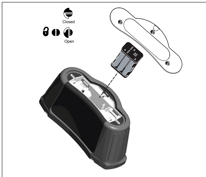
Figure 24. Remplacement des piles
