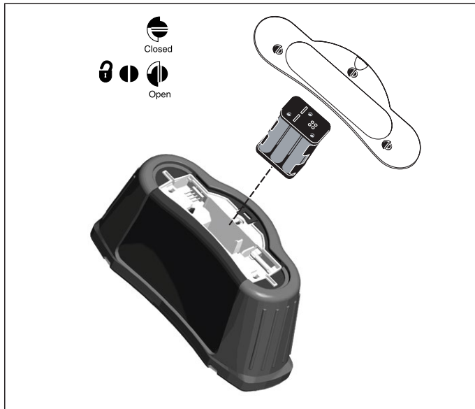
Fig. 24. Udskiftning af batterier
