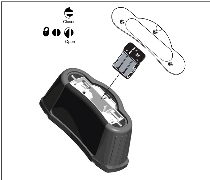
Figura 24. Sostituzione delle batterie
