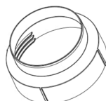
Pyöreä kiinnike ikkuna-aukkosarjalle, joka asennetaan putken päätyosan ja ikkuna-aukon väliin
