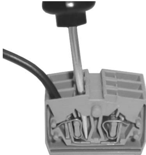
Figure 6– Plaques à bornes dans la boîte de dérivation RSI Ø250.
