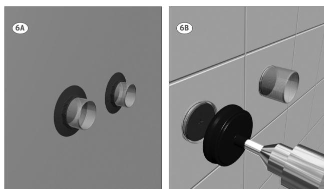
**(DK) 6.** Nu kan du spænde forflangen på med hånden, evt. forsigtigt med en vandpumpetang (6A). Når evt. vådrumsmembran og fliser er opsat, kan du afkorte koblingsdåsens hals til en passende længde med en Roth fræser (6B). Anvend Roths specielle flange, hvis vægbeklædningen er vinyl, PVC eller lignende, VVS-nr. 087274.490.
