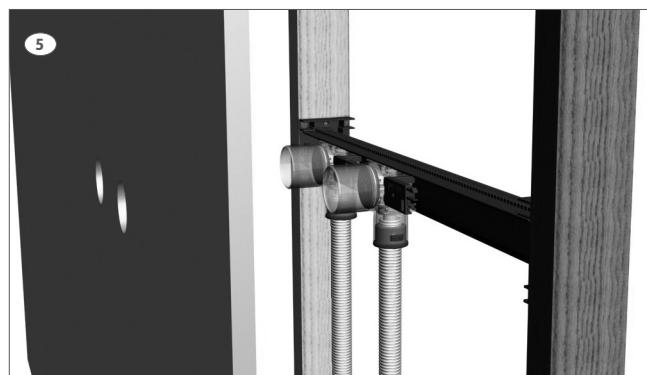
**(NO) 5.** Det er nå en god anledning til å foreta trykkprøving og kontroll da den gjennomsiktige boksen gir fullt innsyn. Veggplatene kan nå monteres etter at det er merket og boret hull med 52 mm hullbor for veggboksene.
