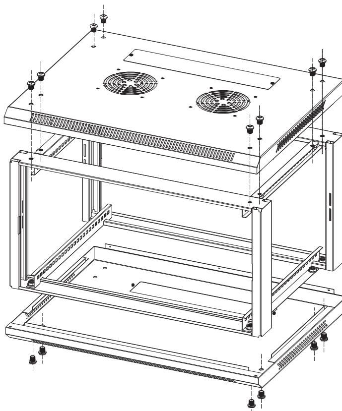
(1) Paigaldage ülemine paneel, raamid ja horisontaaltalad, kasutades M8x12 sisemise kuuskandiga kruvisid (16 tk) ja M8 äärikmutreid (16 tk).
