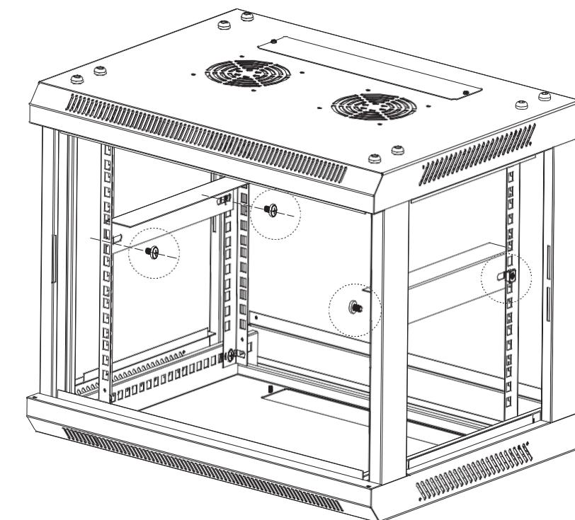
(3) Paigaldage L-tüüpi paigaldustoed, kasutades M6x12 kruvisid (4 tk) ja M6 lukustusmutreid (4 tk).
