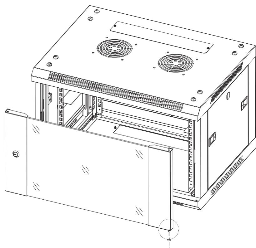
(6) Paigaldage esiuks, kasutades üht valget plastikust seibi ja polti. Küljepaneelid saate paigaldada tööristade abita.
