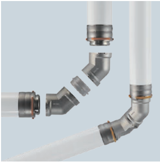
Pielāgojami leņķi — it īpaši vecās ēkās, kur sienas un griesti var nebūt savstarpēji perpendikulāri. Izmantojot starplikas (5 mm) apvienojumā ar diviem 45° leņķa elementiem, var panākt jebkādu leņķi, vienkārši pagriežot komponentus.
