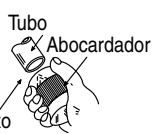
2. Remoção de Rebarbas
