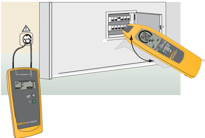
Kuva 3 - Sovellusesimerkki: turvalaitteiden paikantaminen virtapiireistä järjestelmän virtaa katkaisematta.
