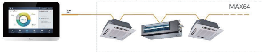
Kuva 1(b) Keskussäätimen liittäminen sisäyksikköön (AC/DC-sisäyksikön ensimmäinen sukupolvi)
