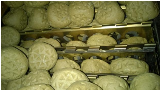
Kivikori asennetuna, Tetra kiviä ladotaan peitoksi
