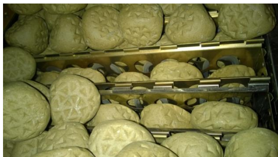
En installerad behållare i ett aggregat med Tetrastenar ovanpå.
