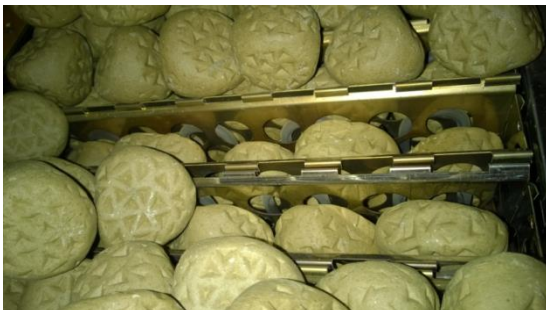
Contenitore installato in un riscaldatore con sopra pietre Tetra.
