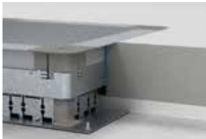
Valurasian kaikki reiät tukitaan toimituksen mukana tulevalla teipillä. Pintavalu valetaan niin että valurasian yläpinta tulee pintavalun kanssa samalle tasolle.
