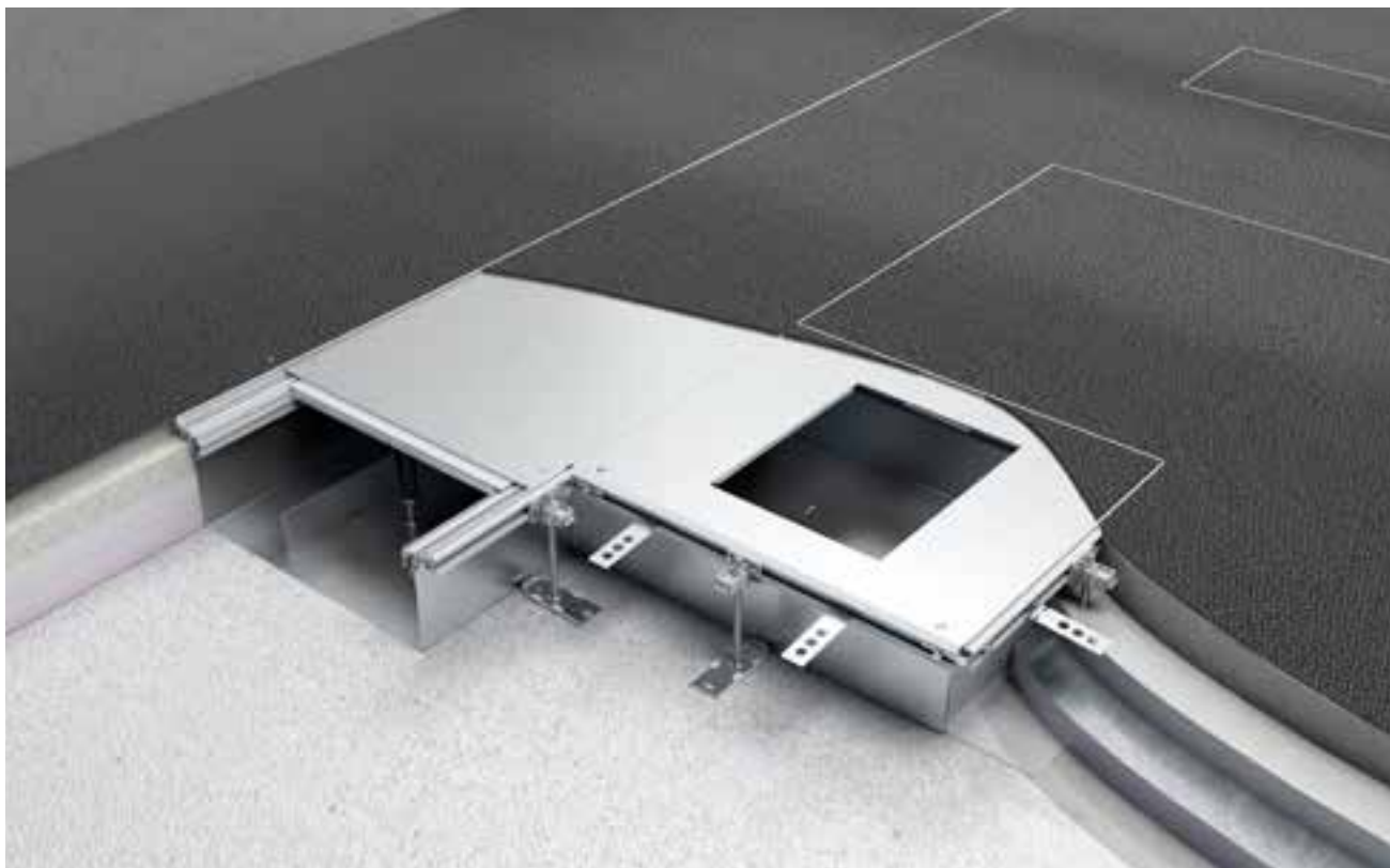
Lattiapinnoite asennetaan kansiin ja valuu. Lattiapinnoitteiden väliin asennetaan saumaprofiili joka estää lian pääsemisen väliin. Kannen alle voidaan asentaa tiiviste, jolloin kanava soveltuu myös märkäpuhdistettaviin lattioihin EN50085-2-2.
