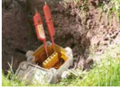
Kovettunut joustava geeli antaa vedenpitävän suojan – IP68. Geeli toimii myös johtimien vedonpoistimena. Sähkömittaukset voidaan tehdä geelin läpi – se tiivistyy itsestään.
