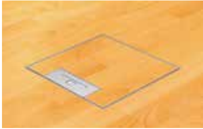
RKS2 4 KR V20 2x3 modulia min. Ø185mm onteloon Pintavalun aukkovaraus 225x225mm RKS2 9 KR 3x4 modulia min. Ø225mm onteloon pintavalun aukkovaraus 270x270mm
