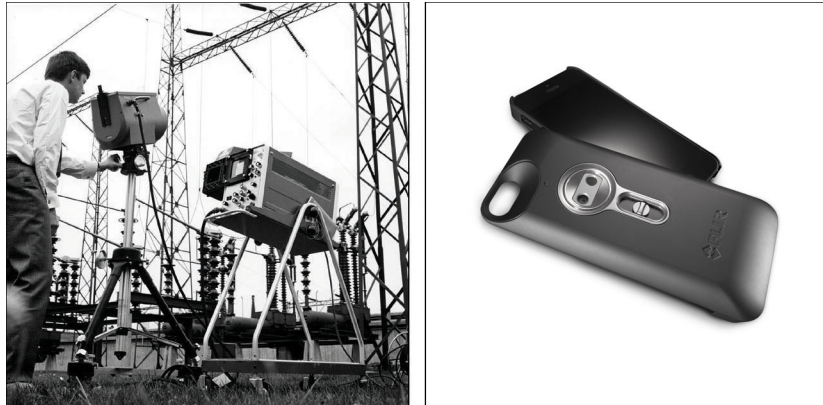
Kuva 13.2 VASEMMALLA: Thermovision-malli 661 vuodelta 1969. Kamera painoi noin 25 kg, oskilloskooppi 20 kg ja jalusta 15 kg. Käyttäjä tarvitsi myös 220 V:n vaihtovirtageneraattorin ja 10 litran säiliön nestemäistä tyypeä. Oskilloskoopin vasemmalla puolella näkyy Polaroid-lisäosa (6 kg). OIKEALLA: FLIR One vuodelta 2014. Paikoilleen liu'utettava lisälaitte, joka mahdollistaa iPhone'n lämpökuvauksominaisuudet. Paino: 0,90 g.
