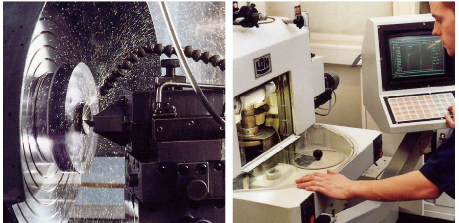
Kuva 13.4 VASEMMALLA: Timanttisorvi; OIKEALLA: Linssien hiontaa
