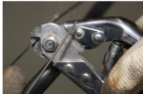
Katkaise teräslangat noin 20 cm:n mittaisiksi.
