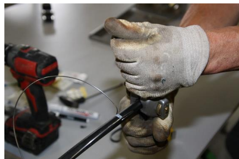
Halkaise vaippa teräslankojen urista käyttäen ST-OCS -vaippakuorijaa.
