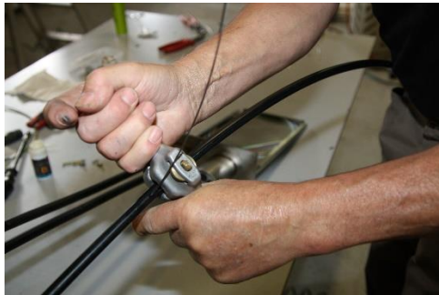
Halkaise vaippa teräslankojen urista käyttäen ST-OCS -vaippakuorijaa.
