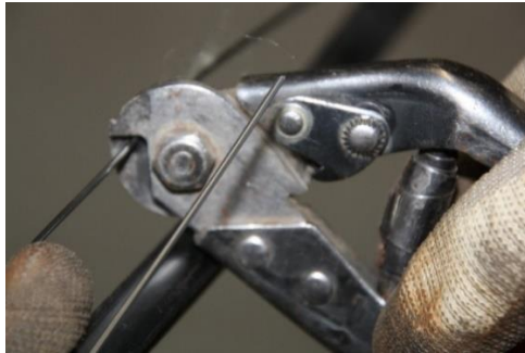
Katkaise teräslangat noin 20 cm:n mittaisiksi.
