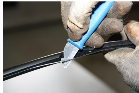
Kaiva teräslangat esille.
