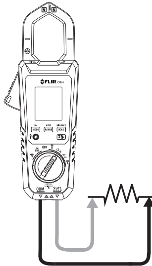
Kuva 5.5 Resistanssin ja jatkuvuuden mittaukset
