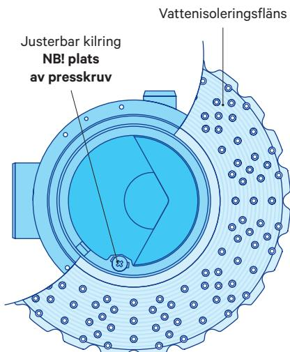
Montering av MERIKA® -vattenisoleringsfläns tillsammans med kvadratiskt lock på golvbrunn i betonggolv
