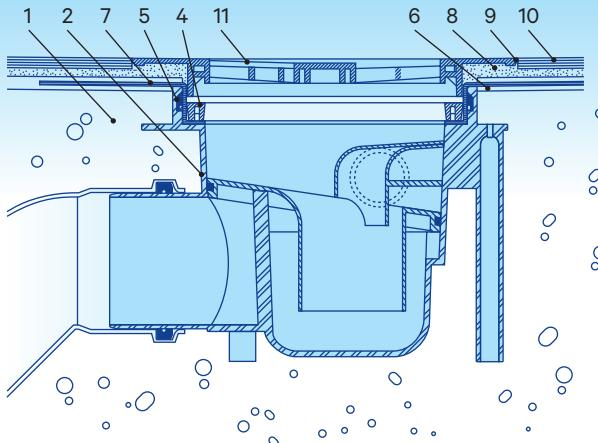
MERIKA® -vesieristyslaipan liittäminen neliökannen kanssa korokerenkalliseen lattiakaivoon lämpöeristetyssä betonilattiassa
