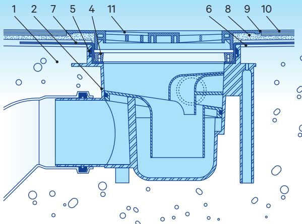
Montering av MERIKA® -vattenisoleringsfläns tillsammans med kvadratiskt lock på golvbrunn med förhöjningsring i värmeisoleringat betonggolv
