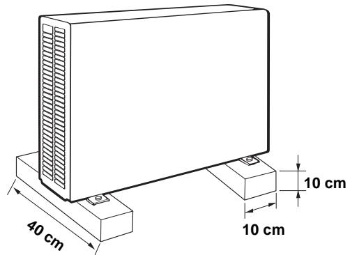
Preparar la unidad exterior sobre una base sólida por encima del suelo y fijarla con los cuatro pernos de expansión.
