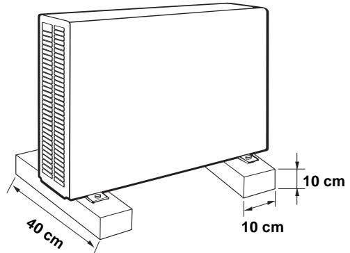
Die Außeneinheit auf eine waagerechte Unterlage stellen (sie soll mit dem Boden in Berührung sein). Die Einheit mit 4 Bolzen sichern.
