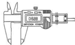
F: Digitaalinen työntömitta TOL - Neljä painiketta
