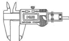
D: Pied à coulisse numérique à 4 boutons "MAINTIEN"
