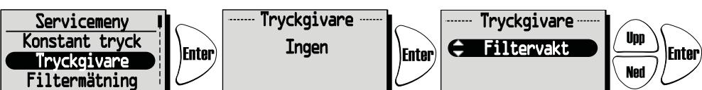
Tryckgivare kan ej användas för HERU®AC. Filtervakt kan användas för både HERU®EC och HERU®AC.
