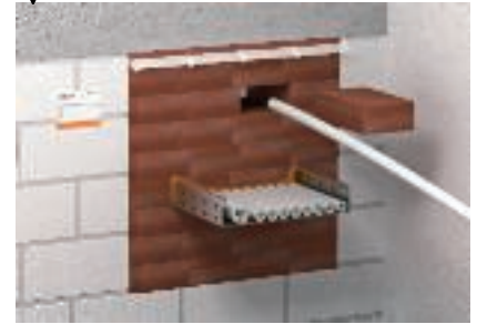
Einfache Nachinstallation durch Herausziehen einzelner Blöcke
