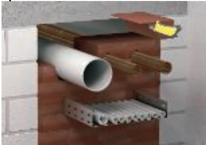
Durchführung brennbarer Rohre ohne zusätzliche Maßnahmen
