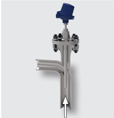
La longitud de montaje y el diámetro de la vaina de protección dependen de los datos del proceso, en particular de la velocidad del caudal del medio a medir.
