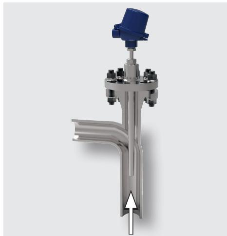
La longueur de montage et le diamètre du doigt de gant dépendent des données process, surtout de la vitesse d'écoulement du médium à mesurer.
