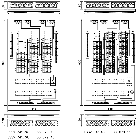
Ryhmäkeskukset SLY1.3 kytkennällä, leveys 545 mm
